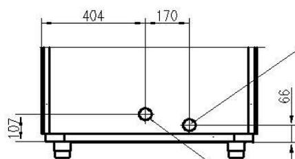
TUBO DI SCARICO Ø INT. mm.28 LUNGHEZZA mm.2000
